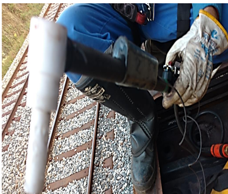
Figura 4. Gatilho desenvolvido para verificação gatilho na bateria. Fonte: Autor (2018).
