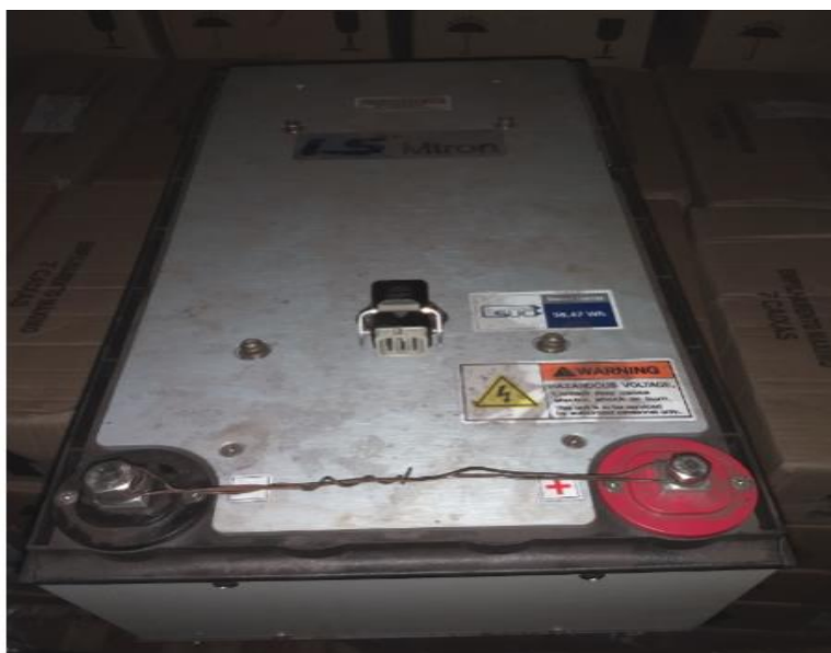
Figura 3. Ultracapacitor LS 86.4V / 93F com polos curto-circuitado S, para armazenamento.
