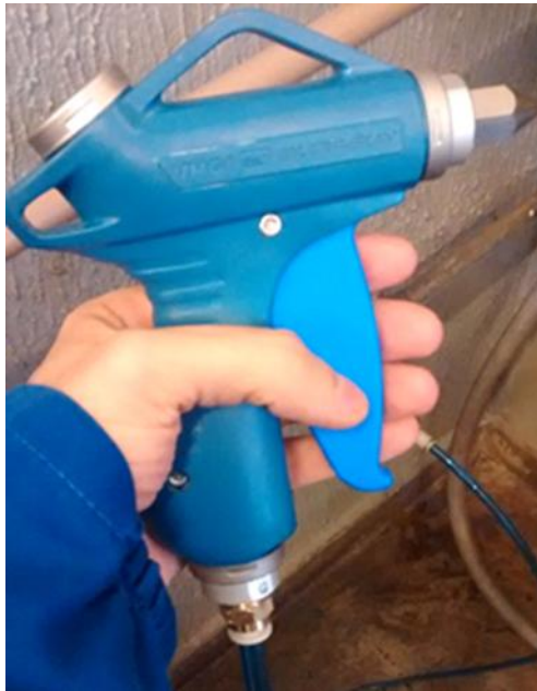
Figura 15 - Pistolas pneumáticas instaladas em pontos isolados de consumo
