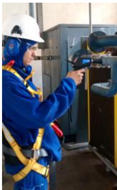
Figura 13 - Detecção de vazamentos por ultrassom
